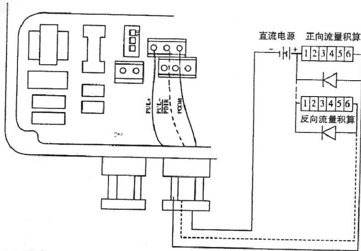
图十三 (b) 电磁计数器接线
