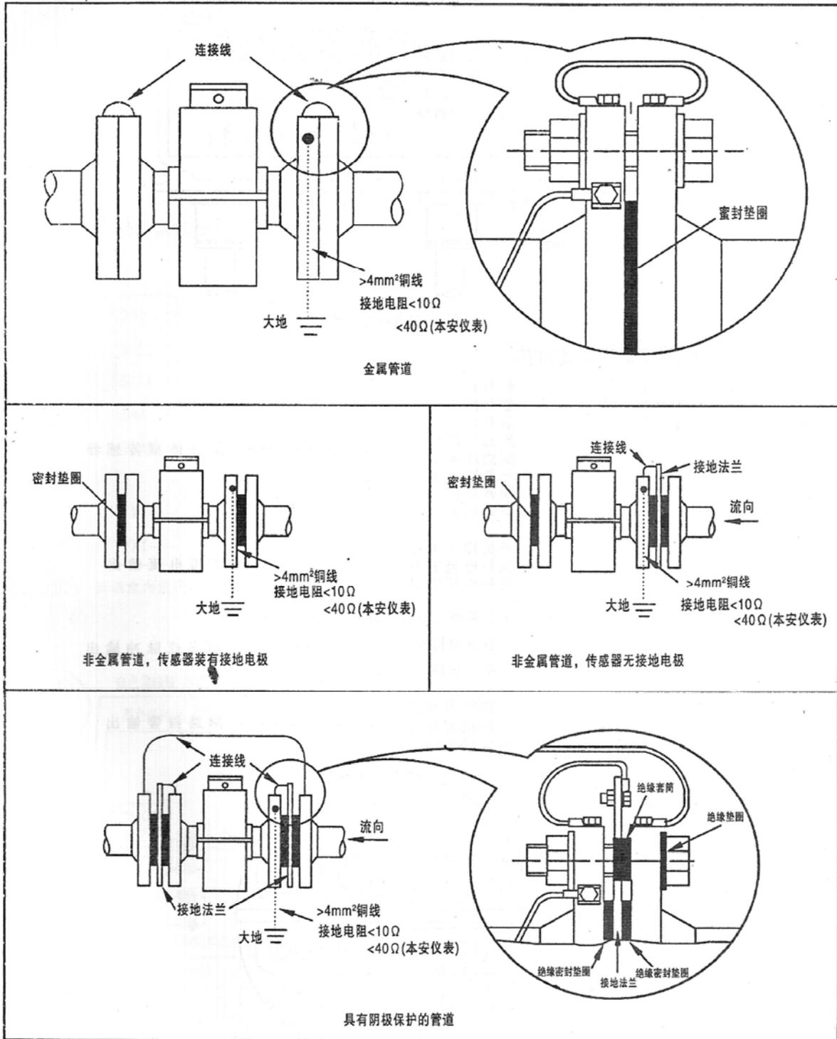
图七 流量计与管道的接地
