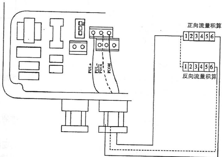
图十三 (c) 电子计数器接线
