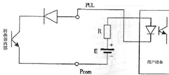
一般，用户光耦需10mA左右电流，因此， $E/R=10\text{mA}$ 左右。 $E=5\sim 24\text{V}$ 。
