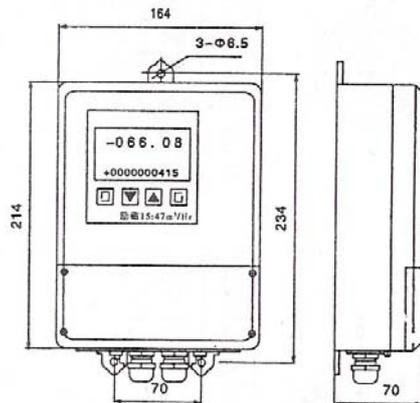
图三（b）方转换器外形
