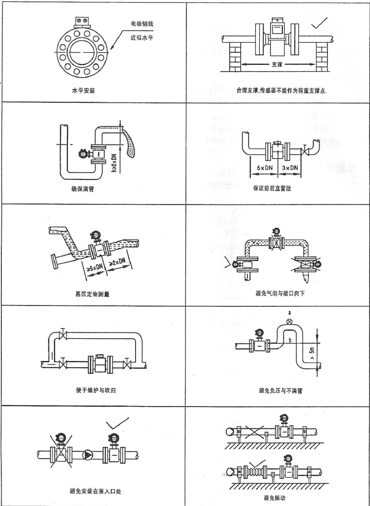
图六 正确安装流量计图示二
