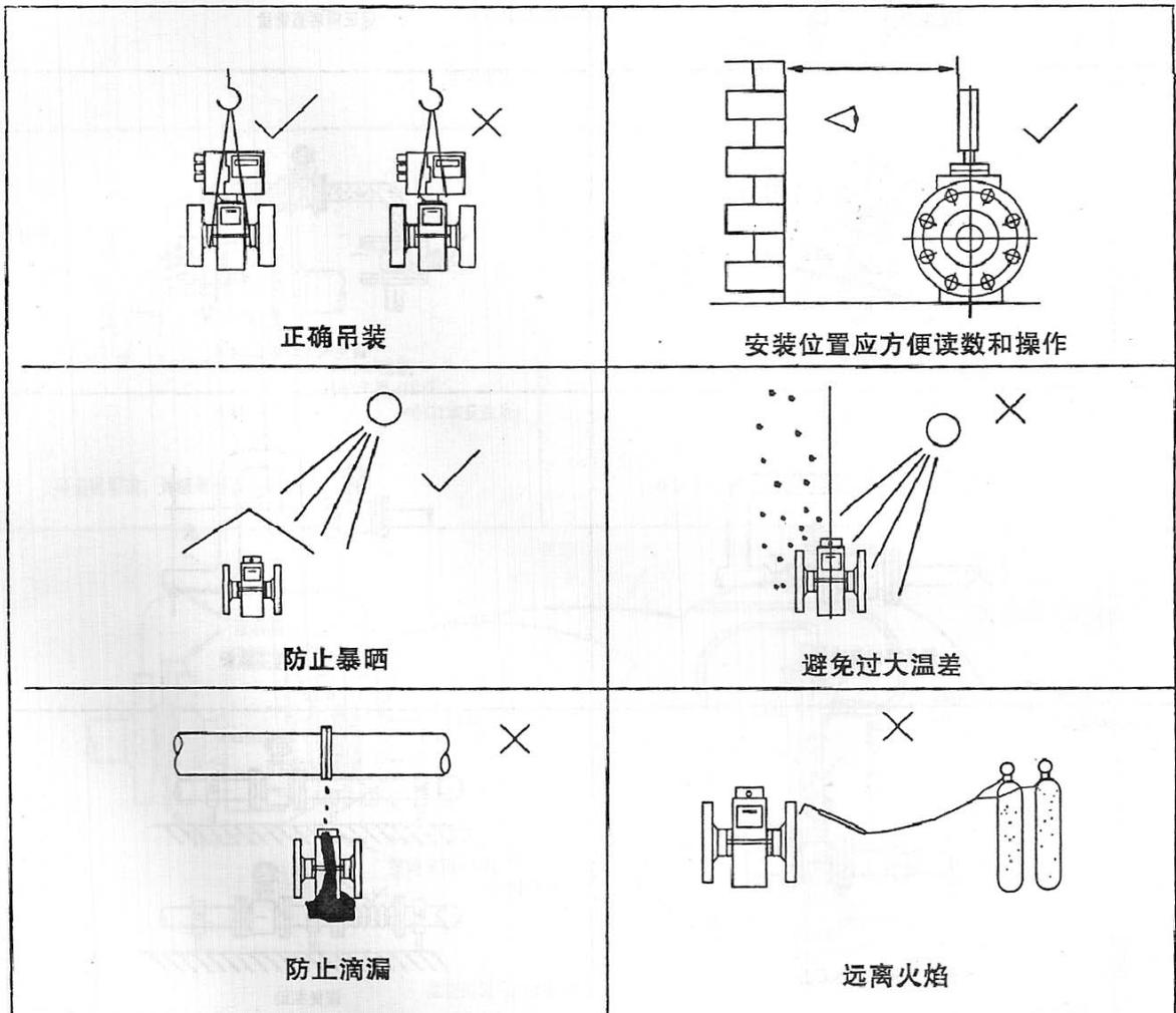
图六 正确安装流量计图示一
