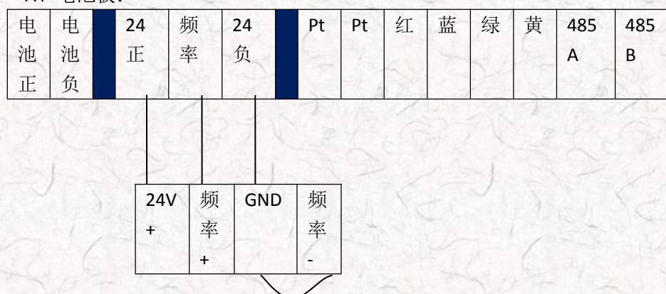
一般情况频率为四线制, 可以将频率负线和 GND 相连从而构成回路, 如果现场接收装置为三线制, 请确认好电压, 按图直接相连即可。
