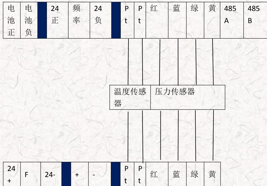
该图示中，两种板子均有多个端口未介绍，该部分为温度和压力接口，在使用过程中一般是出厂设置好的，用于为仪表提供温度或压力补偿，进行补偿运算，客户在使用过程中只要确保该部分接线完好无松动即可，客户在维护过程中可以按照原有接线进行固定。
